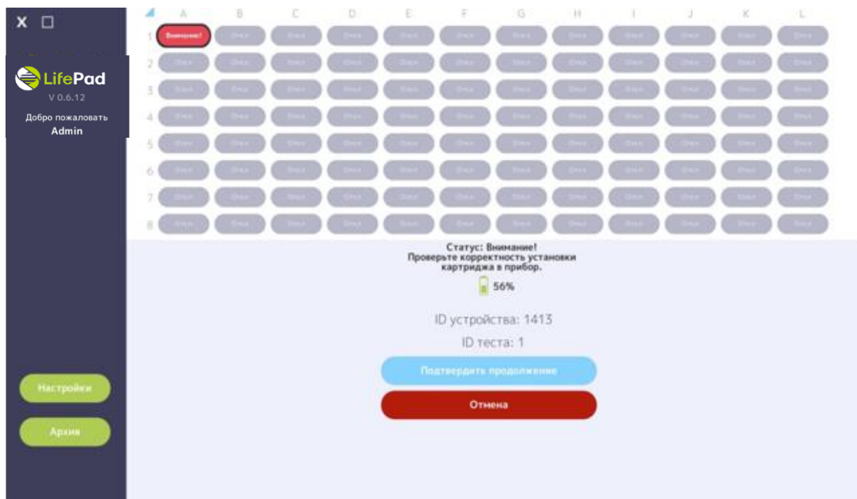
Рисунок 23а. Информирование программным обеспечением «LifePad» о неправильной установке Картриджа в устройстве при использовании персонального компьютера.
