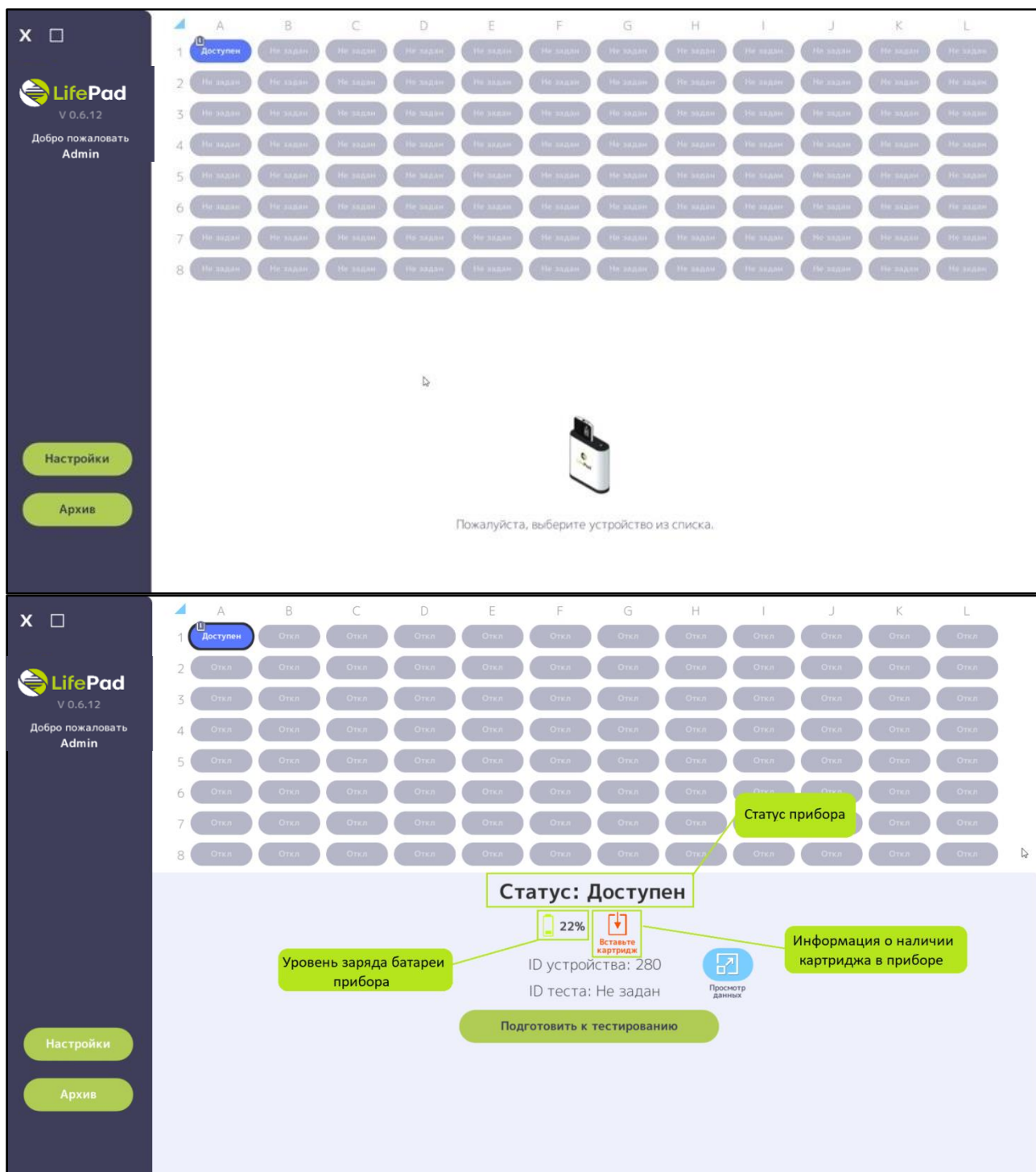
Рисунок 27. Отображение подключенного прибора в одной из ячеек и информация о данном приборе
