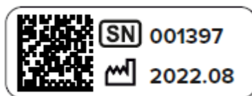
Рисунок 3. Пример маркировки серийного номера и даты производства Анализатора
