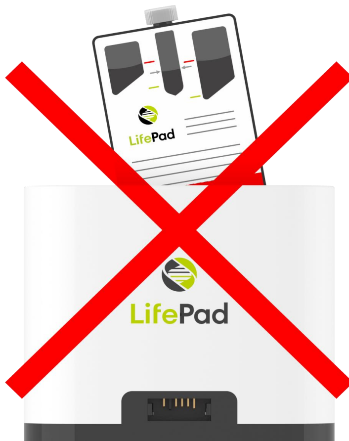
Рисунок 23. Схема неправильной установки Картриджа в устройстве
