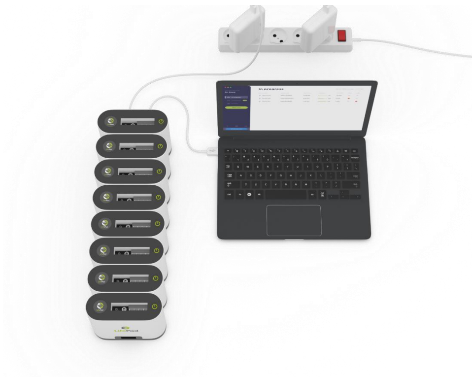
Рисунок 10. Вариант подключения Анализаторов в кластере из восьми приборов
